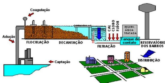
Além disso, a mesma é munida de sistema de reuso, com a finalidade de reduzir as perdas no sistema de tratamento. Todo resíduo das etapas de tratamento é dispensado em uma lagoa situada na área da ETA, com sistema de bombeamento instalado para que haja o retorno para o início do processo de tratamento (Calha Parshall).
